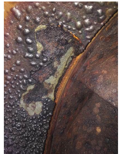
Figuur 1 aangetaste pompschoef door cavitatie
